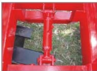
Sistema de cruce de los paquetes de discos
