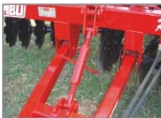
Regulación del nivel de chasis
