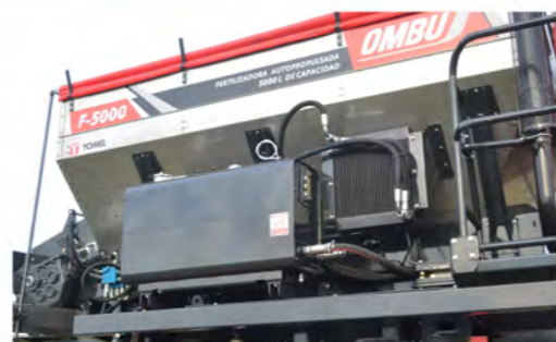
Depósito de aceite y radiador.
