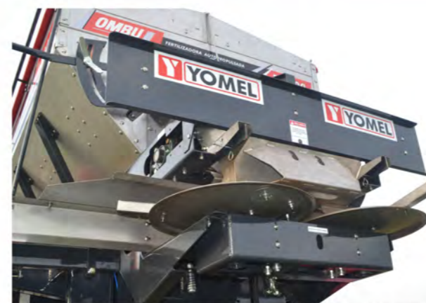
Sistema de distribución Bidisco con paletas móviles para ajuste del perfil de distribución completamente construido en acero inoxidable
