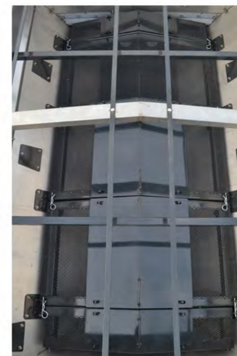
Rejillas interiores y protección para granulados. Protección en Sombrero Chino para polvos.
