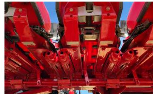
Sistema de rolos en voladizo. Sin bancadas ni puntos de lubricación. Placas gramilleras regulables. Sistema de cuerpos anclados con grampas que facilitan variar la distancia entre líneas.
