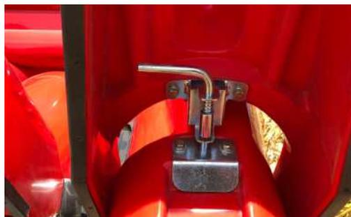
Sistema de traba de puntón a resortes. Disminuye el tiempo de pasaje de posición de trabajo a transporte y viceversa.
