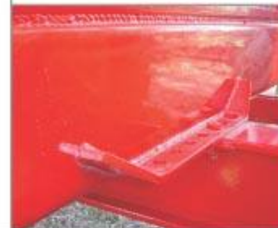
#1 EJE Y CHASIS La robustez del chasis es una de las características sobresalientes de la línea de tolvas autodescargables OMBU. Totalmente reforzado y de construcción en chapa tubular, le asegurará un óptimo desempeño aún en las condiciones más exigentes. El eje es de posición regulable, para lograr un equilibrio perfecto durante el transporte.
