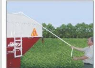
• COBERTURA DE LONA (Opcional) Operación de apertura de la cobertura de lona desde el piso.
