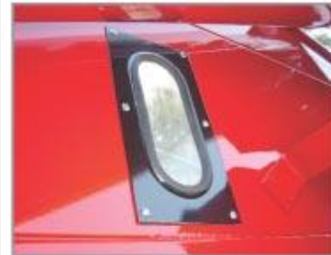
• VISOR Del estado de la tolva.
