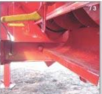
#1 TANQUE DE AGUA (1) #2 CAJA DE HERRAMIENTAS (2) #3 BASE DEL SINFIN HORIZONTAL (3) Como opcional se provee a la base del sinfín horizontal con sistema de desenganche rápido (Sistema Patentado OMBU), lo que evita el estancamiento de agua y desechos, facilitando la limpieza de la tolva para casos de acarreos de distintas variedades de granos. Imprescindibles en recolección para sembreros.
