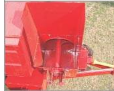
#2 DESCARGA Se puede efectuar por medio del tubo superior o del tubo del sinfín horizontal, en ambos casos se realizará a través de un mando cardánico el cual es telescópico y de sección biavulgar. Además está provisto de un protector y un fusible para evitar roturas. Para casos de emergencia posee una tapa de descarga lateral. Cuenta también con bancada flotante lo que permite un acople seguro del sinfín superior.
