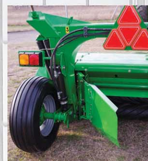
Luces transporte De posición, baliza y giro ubicados en la parte trasera del equipo.
