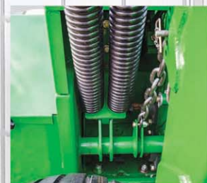
Movilidad grupo segado - acondicionador Robusto con excelente técnica de elevación, suspendido de forma completamente móvil.
