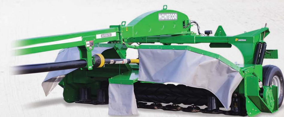
Movilidad grupo segado - acondicionador Robusto con excelente técnica de elevación, suspendido de forma completamente móvil.
