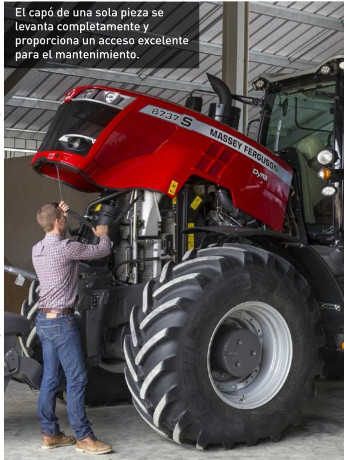
Se puede acceder fácilmente al sistema de refrigeración para limpiarlo y mantenerlo con sencillez. El 90% del polvo se elimina de manera natural por medio del ventilador. Se puede acceder al filtro de aire del motor y limpiarlo con mucha facilidad.
