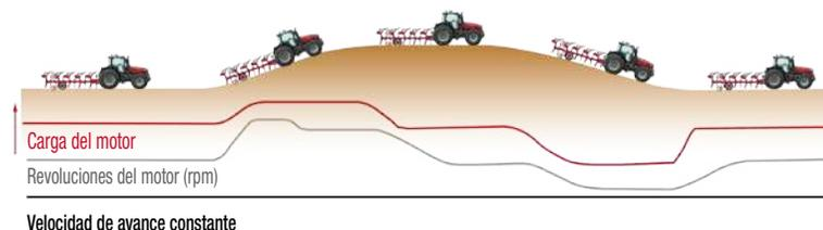
▲ Gestión dinámica del tractor (DTM): a medida que la carga (línea roja) varía en función de las condiciones, la transmisión Dyna-VT ajustará automáticamente las revoluciones del motor (línea gris) para mantener la velocidad de avance con un consumo de combustible y un nivel de ruido mínimos.
