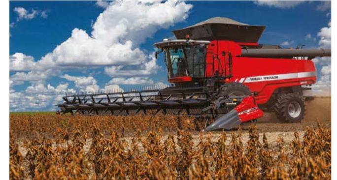
Brazos independientes de inclinación, localizados a cada 76 cm a lo largo de la extensión de la plataforma, son controlados hidráulicamente y con una variación de 0 a 3.000 psi para control preciso y suave. Aun así, con un único toque, la plataforma puede ser convertida en una unidad rígida para cosechas de trigo y cebada, por ejemplo.
