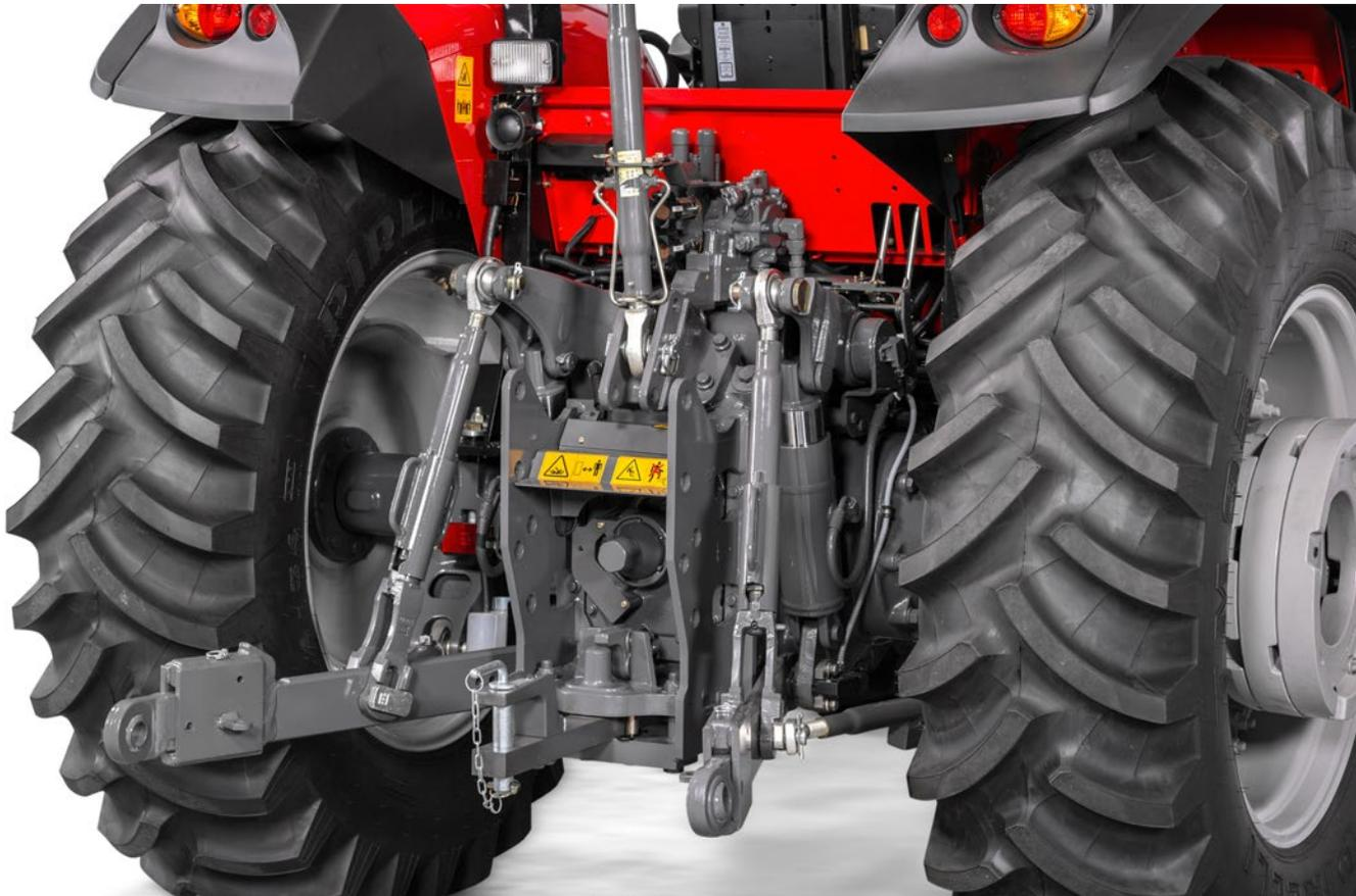
Los tractores de la Serie MF 6700 están equipados con dos cilindros externos, ofreciendo una capacidad de levante de 4950 kg. en su sistema de tres puntos de categoría III / II.
